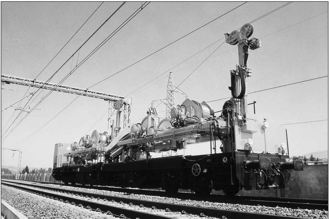
Fig. 1: The FUM 100.128 catenary renewal machine of DB Bahnbaubau GmbH
